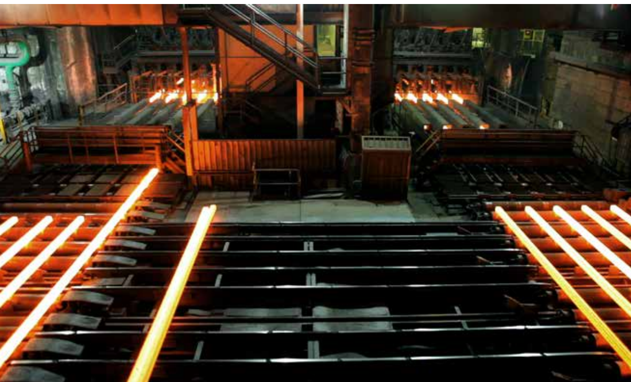
Macchine da colata continua
