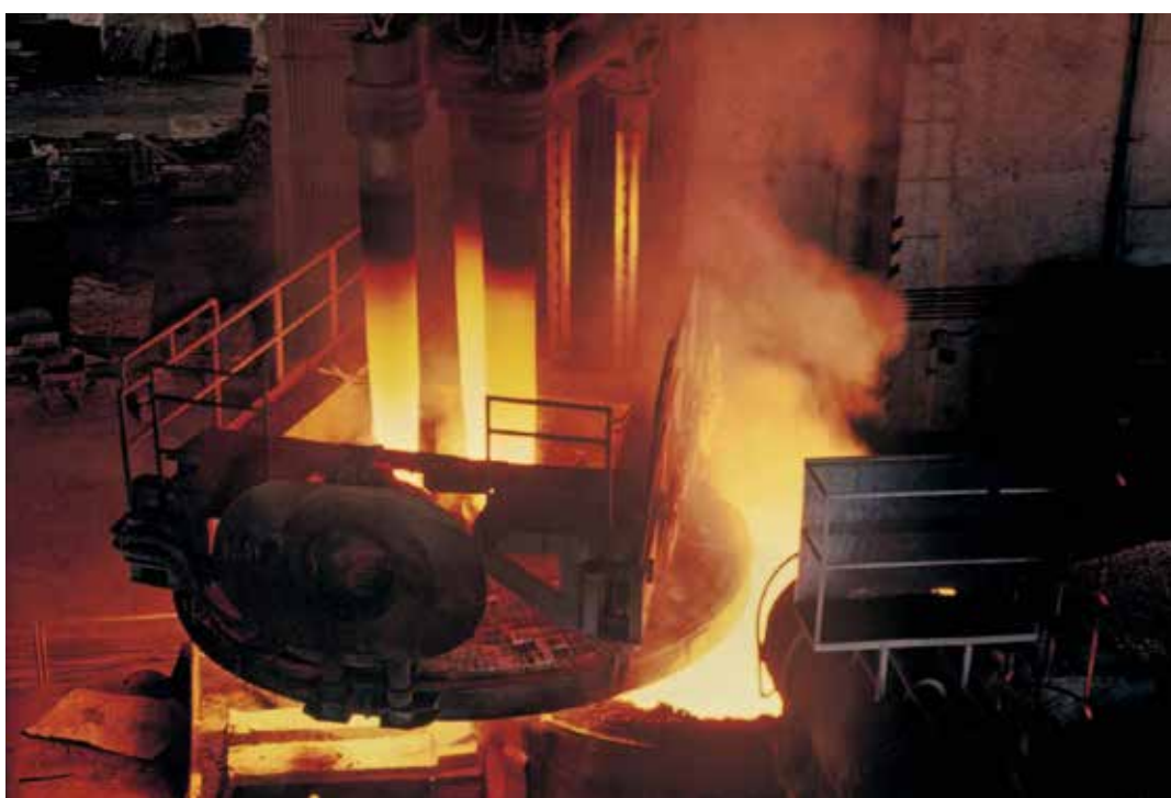
Fase apertura della volta del forno per il successivo caricamento rottame dalla cesta
